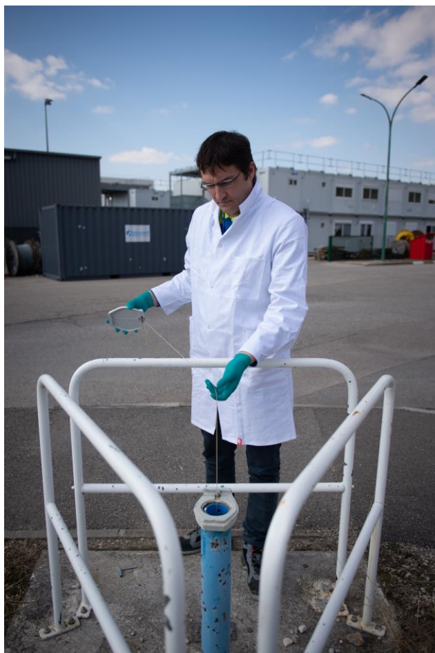
Mesure piézométrique, centrale du Bugey, Ain Copyright EDF / BEAUMONT Romain
